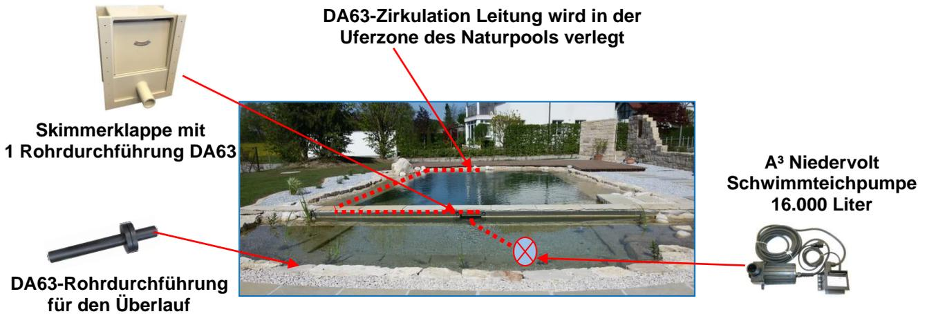
**Belüftung Schema von einem Naturpool mit Uferzone:**
