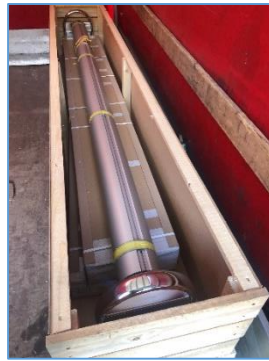
Stirnseite öffnen und Rollabdeckung vom Kistenboden lösen.
